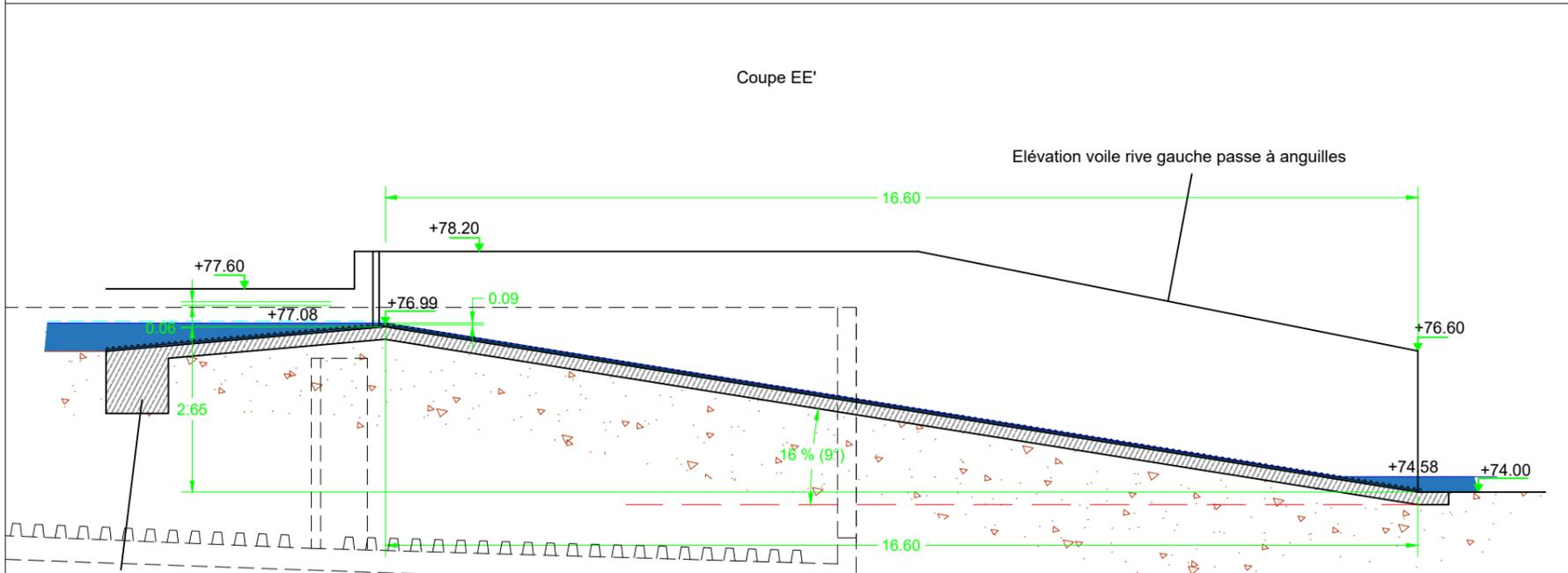
Bèche parafouille et raccordement à l'existant à définir lors des études d'exécution et à adapter lors de la mise à sec
