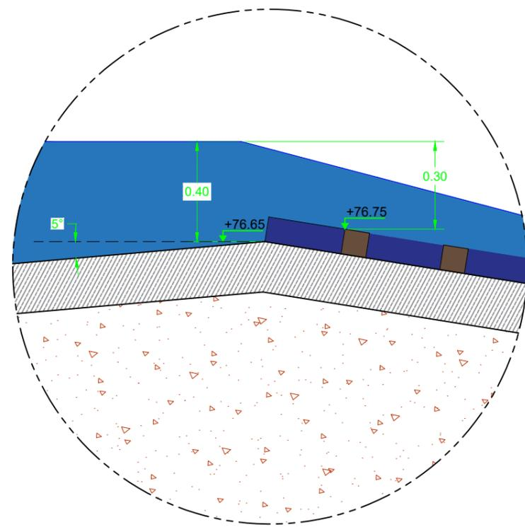
Bèche parafouille et raccordement à l'existant à définir lors des études d'exécution et à adapter lors de la mise à sec
